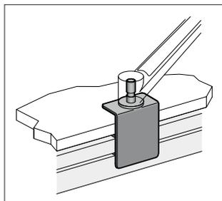
Adaptateur pour bras d'écran orientables sur châssis
