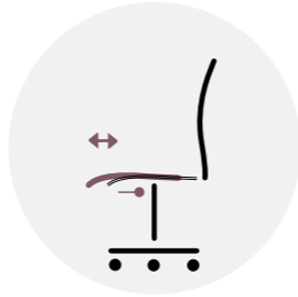
Profondità seduta regolabile (meccanismo con traslatore) Adjustable seat depth (sliding mechanism) Profondeur d'assise réglable (mécanisme coulissant) Einstellbare Sitztiefe (Schiebemechanik) Profundidad del asiento ajustable (mecanismo deslizante)
